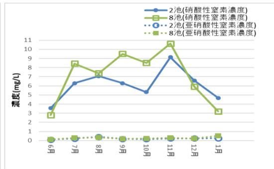
図 14 反応タンク出口の硝酸性窒素濃度等の推移
